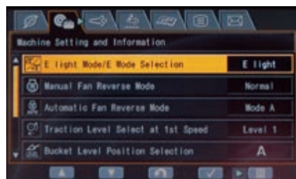
La nuova modalità E-Light del motore consente di ottenere un maggiore risparmio di carburante rispetto all'attuale modalità Economy
