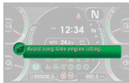
La guida Eco contribuisce al risparmio di energia in tempo reale (ad esempio, evitando lunghi periodi di inattività del motore)
