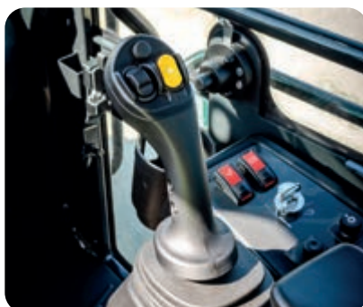
Leva multifunzione PPC con comando elettronico per il 3° circuito idraulico ausiliario
