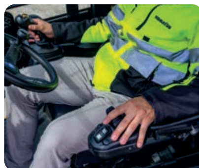
Comfort eccezionale grazie alla console integrata sul lato destro che si sposta insieme al sedile operatore
