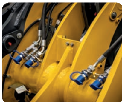
Versione High flow per il 3° circuito ausiliario (160 l/min a 220 bar)
