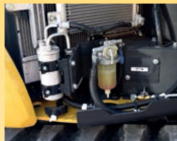
Grande filtro e prefiltra del carburante con separatore di acqua per proteggere il motore
