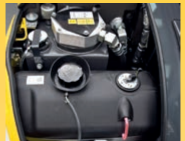
Rifornimento comodo e sicuro di olio e carburante sotto il cofano anteriore
