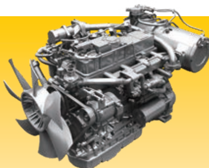
Motore Komatsu 4D88E-7 con sistema common rail ad alta pressione (HPCR) e filtro antiparticolato diesel (DPF)
