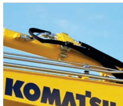
Valvole di sicurezza cilindri braccio e avambraccio
