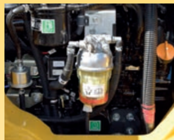
Grande filtro e prefiltro del carburante con separatore di acqua per proteggere il motore
