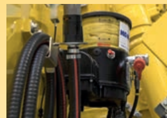
Sistema d'ingrassaggio centralizzato (optional)
