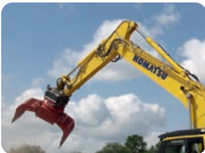
Due linee idrauliche opzionali per montare una serie di accessori
