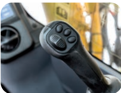
Comandi comodi, ergonomici e precisi: manipolatori con pulsante di comando proporzionale per gli accessori
