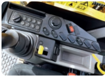
Interruttori raggruppati sulla console destra per garantire una visibilità e un controllo ottimali
