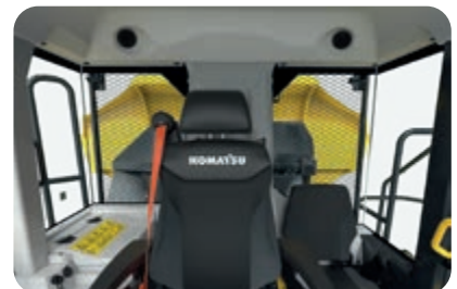
La visibilità posteriore è migliorata grazie all'eliminazione dei montanti posteriori sinistro e destro
